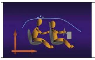
E será jogado para cima também, contra o teto do carro, porque em uma colisão frontal a traseira do carro é impulsionada para cima, levantando rapidamente as rodas do chão. Dependendo de sua altura, o passageiro baterá a cabeça contra o teto.
