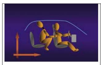
O problema é que ao mesmo tempo em que o passageiro é jogado contra o teto, seu corpo continua se deslocando para frente, na direção do banco da frente. O teto segura a cabeça da pessoa, ocorrendo, então, o risco de uma flexão extrema do pescoço. Essa flexão pode provocar uma fratura da coluna cervical que, muitas vezes, é seguida do ferimento da medula espinhal - a lesão medular.
